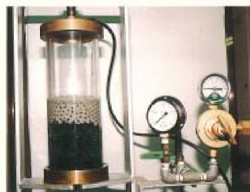
泥水を払い出した状態 (アクリシールが間隙をプラグしている)
