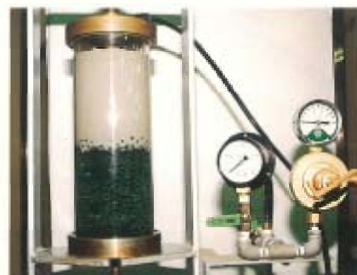
アクリシール8%混合泥水張込
